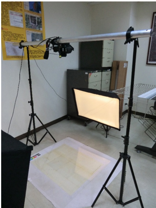
写真2 スキャン室における非接触型スキャン設備
