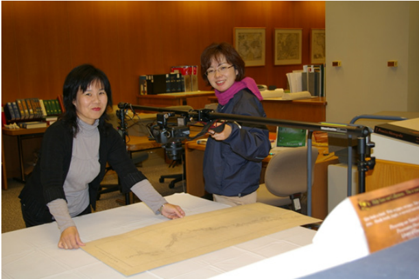
図 10：マンプロット製の背景紙サポートシステムに装着したキヤノン EOS5D を使用した手描き原図の写真撮影。このシステムは三脚ではないので不安定ではあるが、カメラのレンズを真下に向けて、水平に置いた手描き原図を撮影するのに適している。
