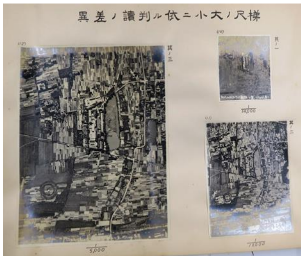
図1：b003『空中写真判読資料』の一例（同じ場所の縮尺のちがう3つの写真により、解像度の差を图示）
